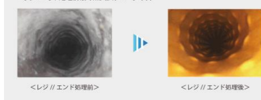
■レジ//エンド処理前後の熱交換チューブ写真
