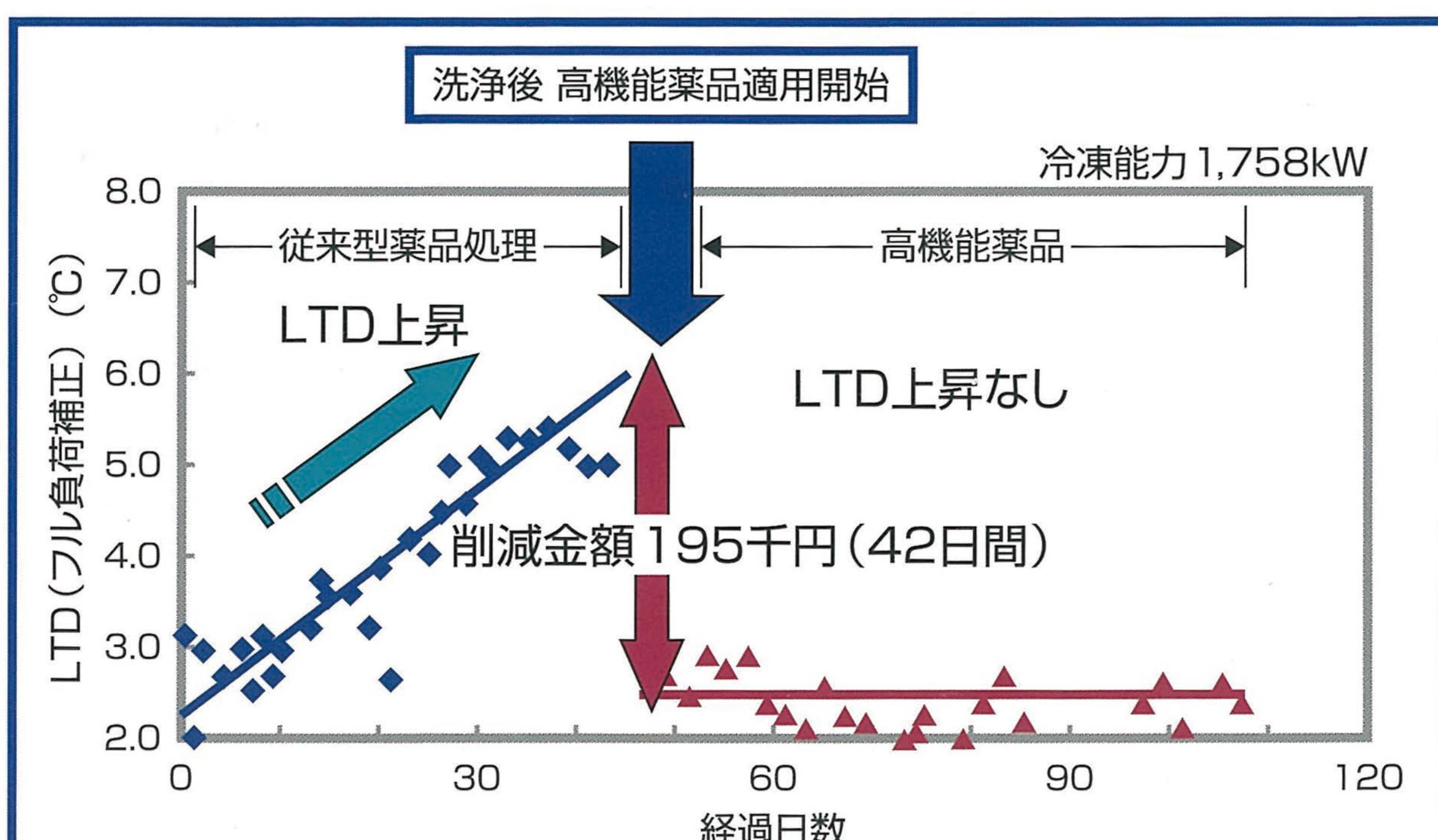
LTD (Leaving Temperature Difference)は、冷凍機凝縮器における冷媒凝縮温度と冷却水出口温度との温度差。
